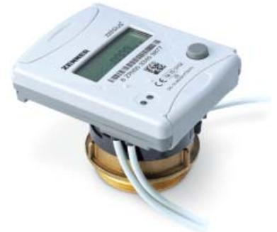
Se designan como «Combi» los contadores de energía térmica compactos de ZENNER en los que el calculador se puede desmontar del sensor de flujo, pero está conectado a este de forma inseparable mediante un cable. Los aparatos Combi se utilizan p. ej. cuando el punto de montaje presenta dimensiones reducidas y no hay espacio para el calculador en el sensor de flujo o no resulta bien legible.
